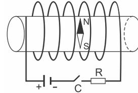
Determine o módulo do vetor indução magnética no interior do solenoide quando a tensão for de 60 V. Dado  $\mu_0 = 4\pi \times 10^{-7} \text{ T}\cdot\text{m/A}$ .
