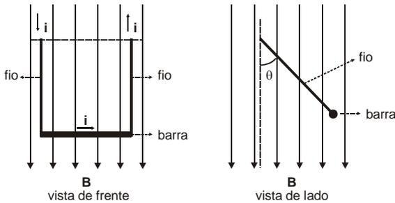
Ao circular uma corrente  $i$  pelo balanço, ele se inclina, e, no equilíbrio, forma um ângulo  $\theta$  com a vertical (como indicado na vista de lado). O ângulo  $\theta$  depende da intensidade da corrente  $i$ . Para  $i = 2$  A, temos,  $\theta = 45^\circ$ . Adote  $g = 10 \text{ m/s}^2$ .
