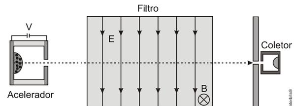
Os isótopos ionizados com carga q são acelerados por uma diferença de potencial V. Em seguida, passam por uma região, o filtro, onde estão aplicados um elétrico E e um campo magnético B, perpendiculares entre si. Considerando o exposto e desprezando os efeitos gravitacionais, calcule a massa do isótopo que chega ao coletor em função de q, V, E e B.
